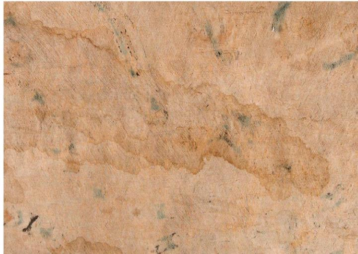
**Fig. 5b.** Faltante y manchas de óxido por grapas metálicas.
