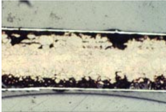
Foto 1: Metalografía de una pieza elaborada en tumbaga dorada por oxidación que muestra la corrosión interna.
