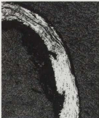
Figura 16: Fotomicrografía de una sección longitudinal del cascabel que aparece en la Figura 15. Nótese las líneas alargadas, comprimidas y alineadas que resultan de la deformación intensiva del metal en el proceso de martillar
