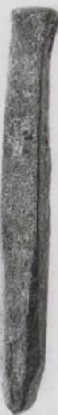
Figura 14: "Clavo" (MIT 3984), excavado en la pirámide Akapana en Tiwanaku, Bolivia. El metal con que se fabricó es la aleación ternaria de cobre-arsénico-níquel: 1.34% As, 1.33% Ni.
