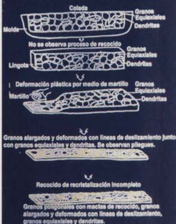
Figura 7: Posible proceso de metalurgia física Sicán
