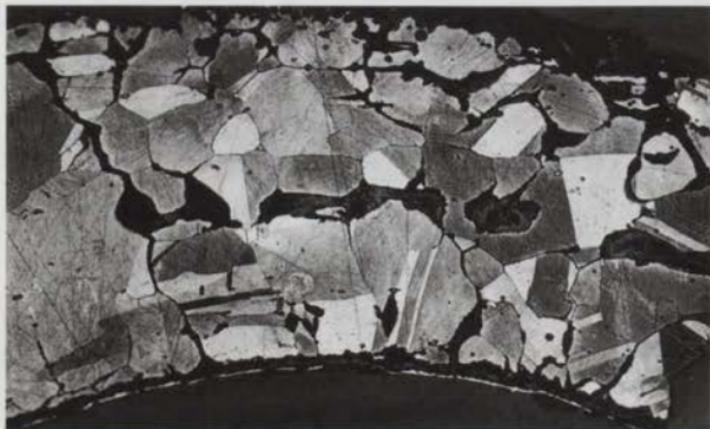
**Figura 12:** Fotomicrografía del corte transversal de una muestra Vicús de lámina de cobre dorado [MMA1987.394.252], luego de ser tratada con una solución alcohólica de  $FeCl_3$  Magnificación: 20X.
