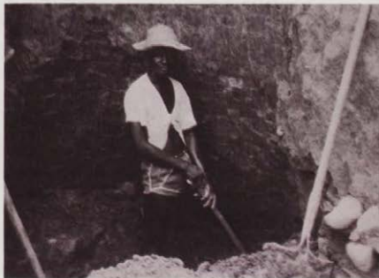
Tecnificación de la minería: el manejo del chorro de la motobomba para excavar y lavar tierra.
