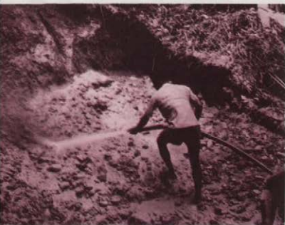
Tecnificación de la minería: el manejo del chorro de la motobomba para excavar y lavar tierra.
