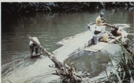
Tecnificación reciente de la minería: una mina de agua corrida, excavada con motobomba. El "frente" de la mina se ve en el fondo; en el canal se van asentando las arenas auríferas que las personas están en proceso de lavar. Los tubos negros conducen el agua del río hasta el frente de la mina.
