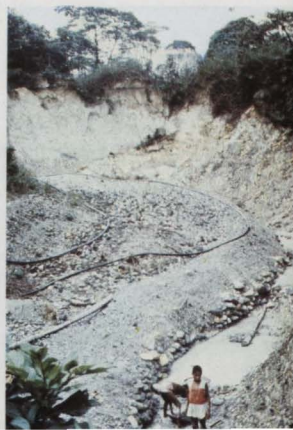
Tecnificación reciente de la minería: una mina de agua corrida, excavada con motobomba. El "frente" de la mina se ve en el fondo; en el canal se van asentando las arenas auríferas que las personas están en proceso de lavar. Los tubos negros conducen el agua del río hasta el frente de la mina.
