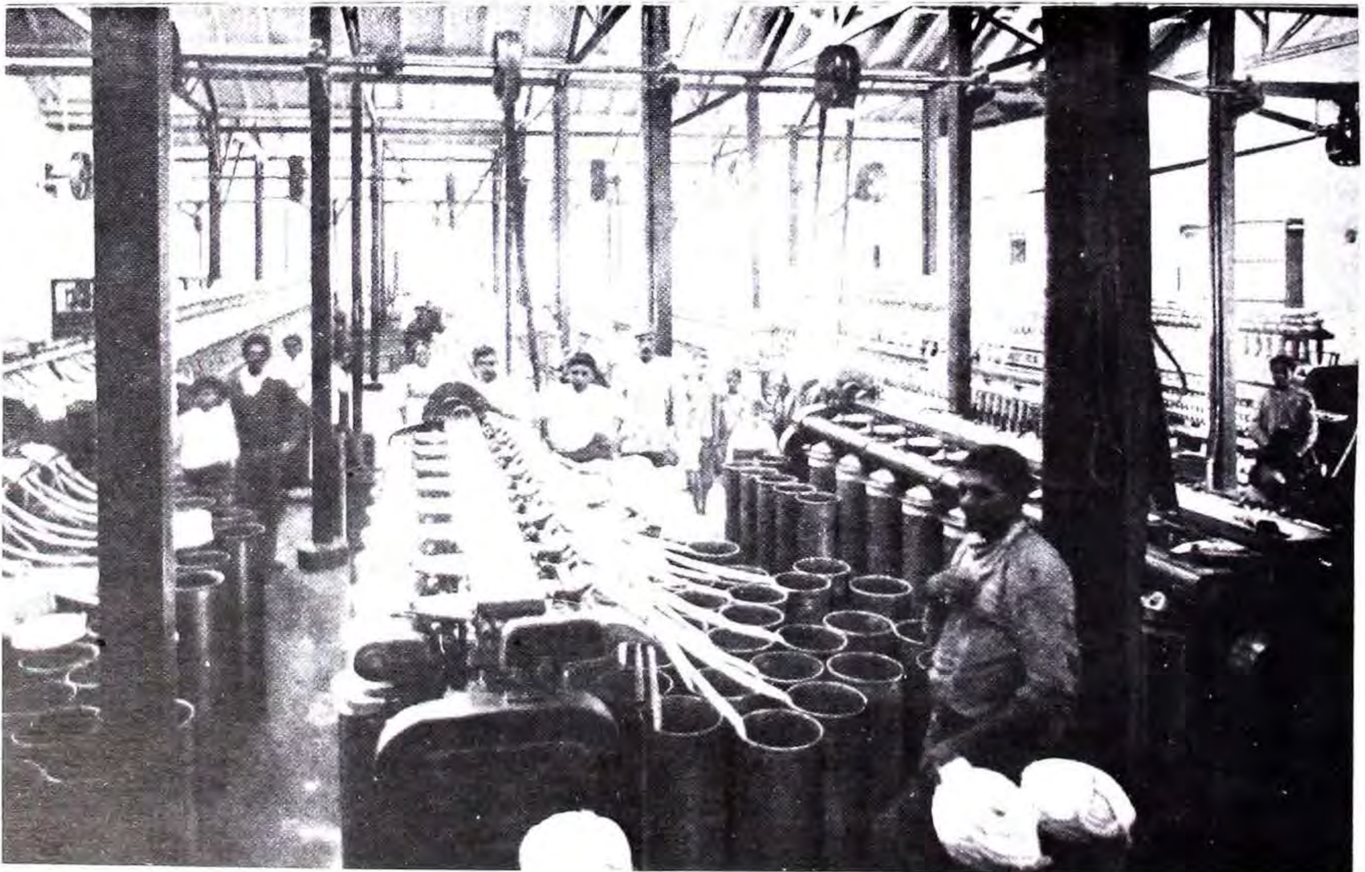
Maquinaria textil de la fábrica de Bello. Era movida por fuerza hidráulica. Producían telas de algodón, paños y pañolones. Medellín el 20 de julio de 1910. S. M. P., 1910.
