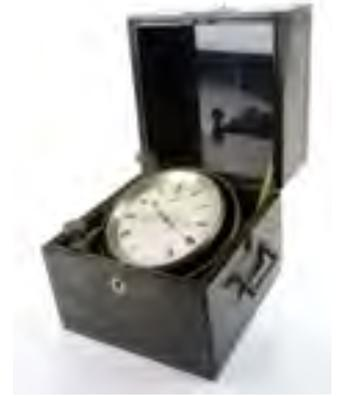
Cronómetro marino, Benson [constructor], Londres, finales del siglo XIX [entre 1874 y 1904], en caja de palisandro con doble tapa, con bisagras y asas de latón lacado.
